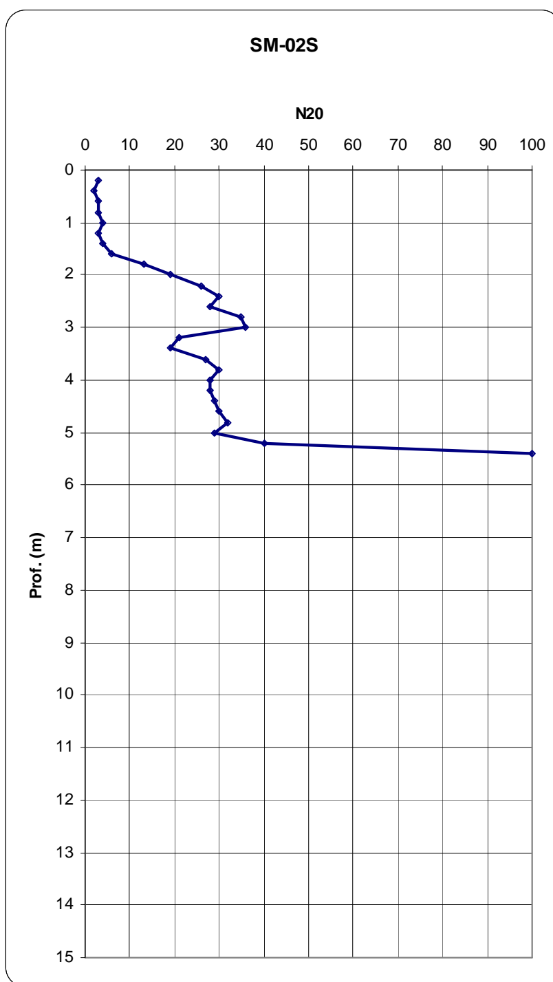
Figura Nº 4.- Registro del ensayo a penetración dinámica SM-02S
