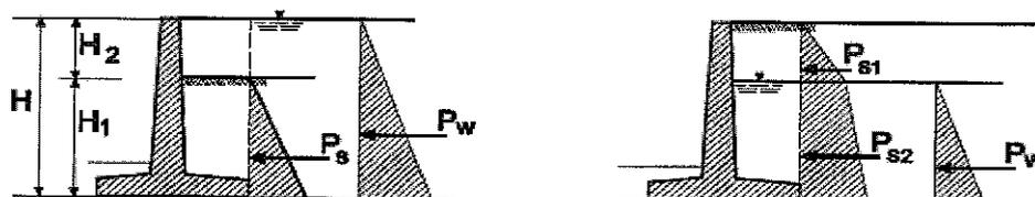
Figura N° 24.-Empujes del terreno y del agua con trasdós vertical y superficie del terreno horizontal
