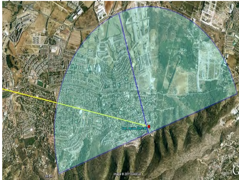
Cobertura de los sectores Wimax del emplazamiento Depósito de Casas Blancas – Estación Base Nº4
