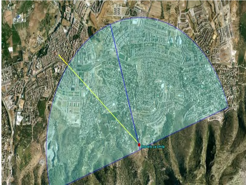
Cobertura desde emplazamiento Depósito de Agua de la Ermita – Estación Base Nº3
