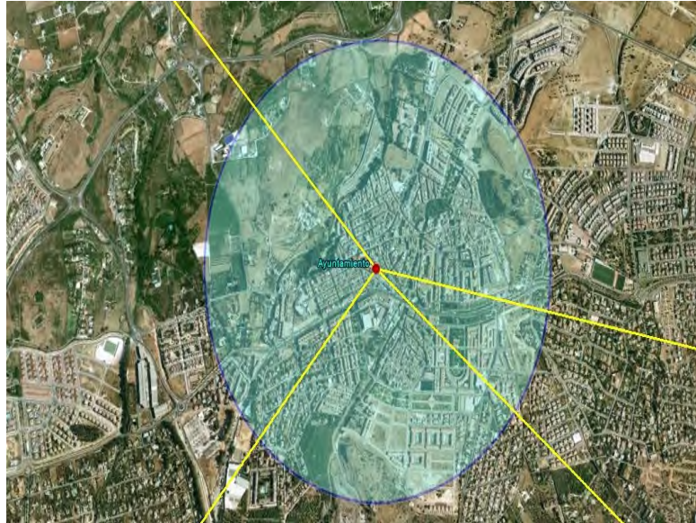
Cobertura desde emplazamiento Ayuntamiento– Estación Base N°1
