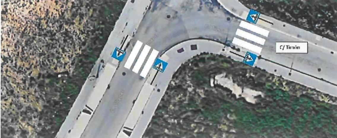
Que, por tanto, en base a las razones expuestas ut supra y, al tratarse de una vía de salida de la zona escolar del centro C.E.I.P. Algazara y I.E.S. Galileo, se estima procedente la instalación de cuatro señales verticales S-13 de pasos de peatones (una para cada sentido de los dos pasos) y el repintado horizontal de los mismos, al objeto de reforzar la visibilidad de los mismos y mejorar la seguridad vial en la zona.
